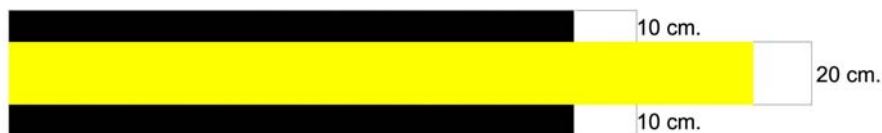
Figura 35. Segnaletica di barra d'allineamento della piazzola di sosta "305"
