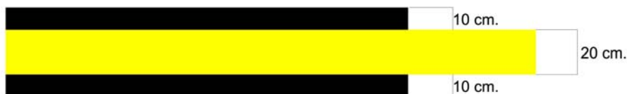
Figura 19. Segnaletica bordata con due strisce larghe 10 cm di colore nero
