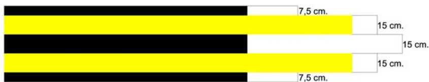
Figura 5. Segnaletica bordata con due strisce larghe 7,5 cm e spaziatura interna di 15 cm di colore nero
