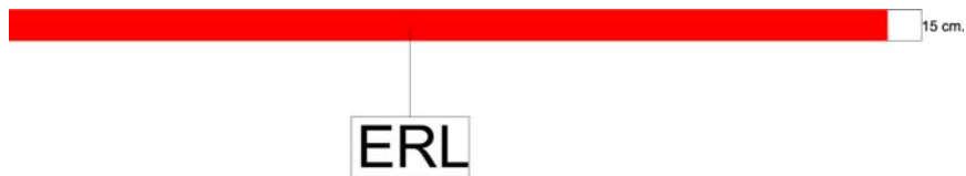
Figura 11. Segnaletica continua con una striscia larga 15 cm di colore rosso
