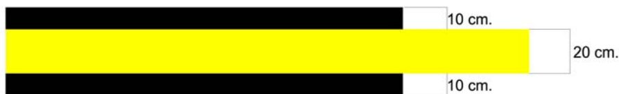
Figura 2. Segnaletica bordata con due strisce larghe 10 cm di colore nero
