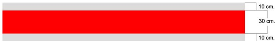
Figura 7. Segnaletica continua bordata con due strisce larghe 10 cm di colore bianco
